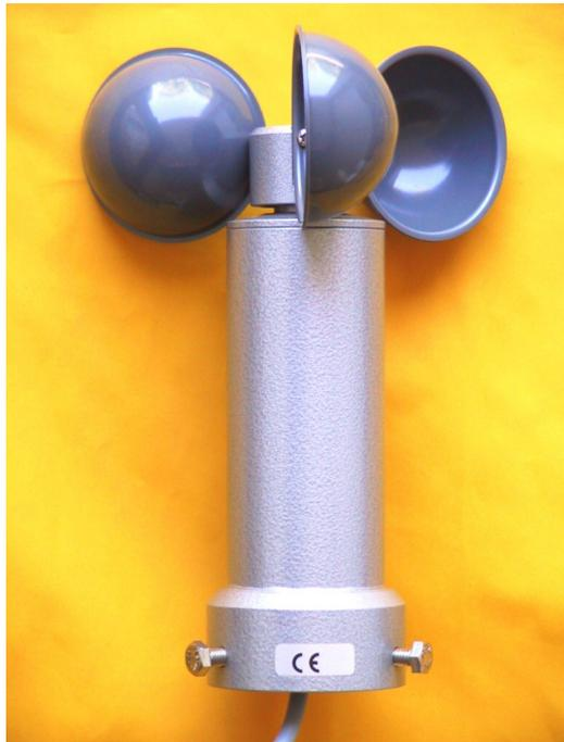
Windgeber/Windsensor mit Heizung Messbereich 0...35 m/s andere Bereiche sind möglich Analogausgang 0...10 V Betriebsspannung 24VDC
